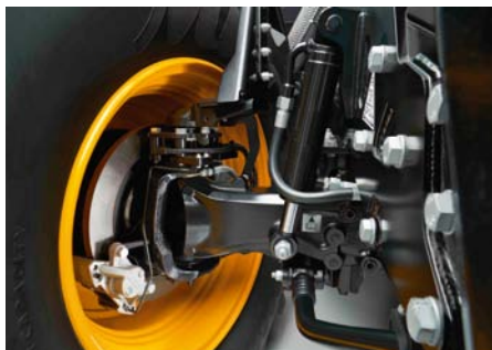
Fastrac si zachoval všetky špecifiká ako individuálne zavesené a hydropneumaticky odpružené obe nápravy, kotúčové brzdy s ABS, maximálnu rýchlosť 64 km.h -1 , ovládanú zadnú nápravu.
