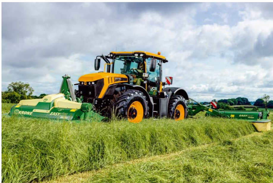
Smart Transmission Control je nový systém, ktorý umožňuje operátorom nastaviť požadovanú rýchlosť, pričom elektronika sama nastaví otáčky motora a prevodový pomer.
