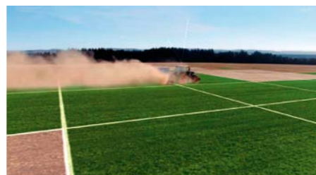
Sekčné riadenie, variabilné dávkovanie, ale aj Tractor Implement Management pre vzájomné riadenie traktor - náradie obsahuje Gen7.
