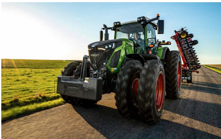
Fendt 900 vyniká nízkootáčkovým konceptom a pohonom VarioDrive, ktorý poháňa prednú a zadnú nápravu nezávisle na sebe.
