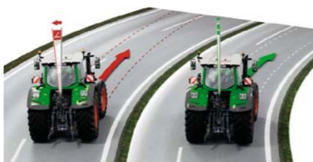
Do ovládania integrovaná regulácia tlaku v pneumatikách či Stability Control pre kontrolu náklonu v zákrutách sú zaujímavé prvky znižujúce utlačenie pôdy a zvyšujúce bezpečnosť.
