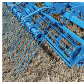
Za radličkovou sekciou nasledujú urovnávacie prsty a sekcia zložená napríklad z valca a zavlačovača.
