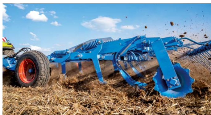
Radličková sekcia má dvojité istenie – pružinou a strižnou skrútkou.
