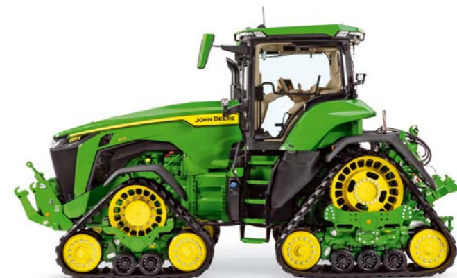
Osmičková séria traktorov je výnimočná v tom, že ponúka až tri typy podvozkov – kolesový, dvoj- pásový a štvorpásový.
