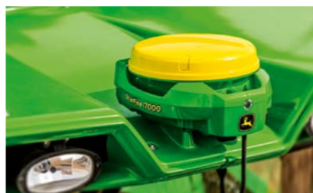
Prijímač StarFire 7000 dosahuje základnú presnosť +/- 2,5 cm bez pozemnej RTK stanice a korekčného signálu.
