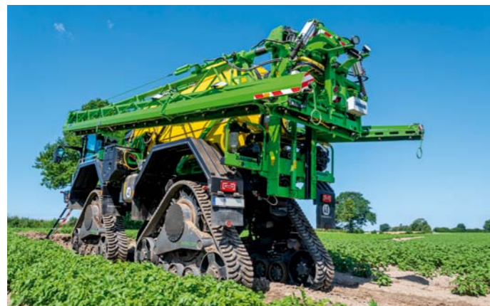
Dammann odporúča pásový podvozok pre postrek kultúr, ako sú napríklad zemiaky. Pásy môžete zameniť za kolesá v priebehu dvoch hodín.
