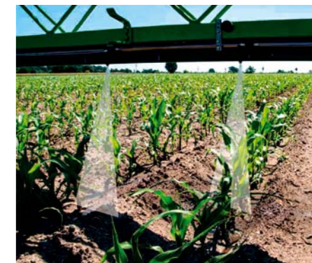
Dammann s RSD sa ideálne kombinuje s mechanickou likvidáciou burín v medziradičkách. Dýzy sa na riadok posúvajú manuálne, podľa GPS alebo kamerového navádzania.
