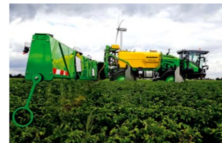
Vzduchová podpora postreku Dammann DAS asistuje postrekovému lúču spredu aj dozadu.
