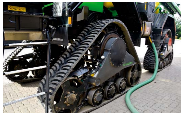
Veľké hnacie koleso s priemerom 1 163 mm, pevné oceľové kladky a 16 palcov široké pásy charakterizujú Delta pásy, ktoré taliansky výrobca dodáva aj na kombajnovú techniku.
