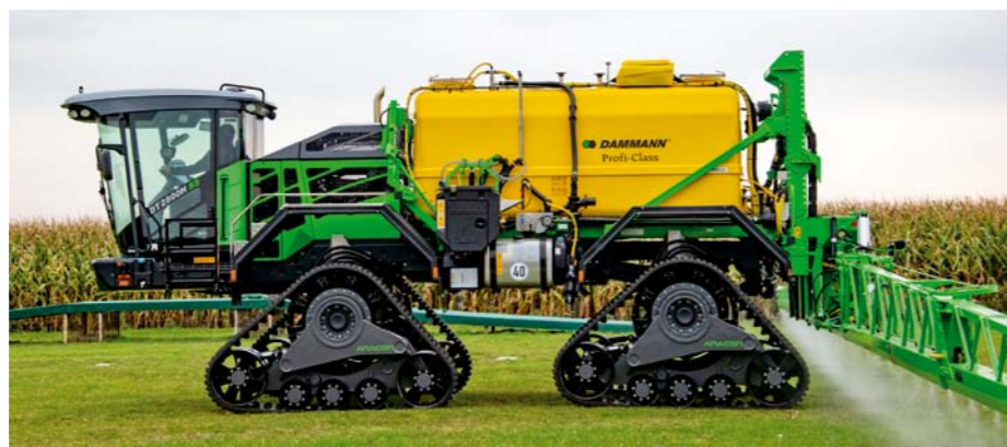
Osadením pásov podvozok nestráca svoje manévrovacie schopnosti. Jediným obmedzením v porovnaní s kolesami je maximálna rýchlosť 25 km za hodinu.
