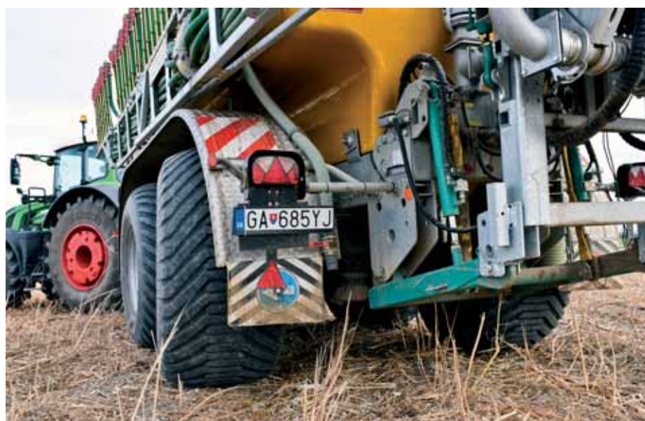
Voz spočíva na dvojitej vzduchom odpruženej náprave s riaditeľnou zadnou nápravou. Sfkovanie predných vankúšov znižuje negatívne ťažisko a zvyšuje trakciu.
