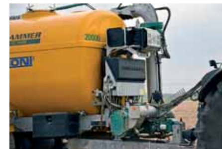
Hydraulicky poháňané čerpadlo dokáže presne dávkovať iba 3 m 3 tekutiny na hektár nezávisle na jazdovej rýchlosti. Signál o rýchlosti elektronika odoberá z GPS.
