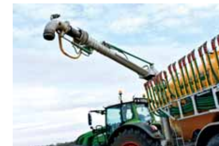
Rameno Gunny Swing s dosahom 3,7 m urýchľuje plnenie cisterny. Potrebu manévry traktora obmedzuje aj hydraulicky vysúvateľná koncovka.
