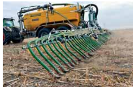
Pätkový aplikátor Glide-Fix so záberom 18 m má pokojný chod a presne kopíruje nerovnosti. Pätky vytvárajú jemné drážky, ktoré pomáhajú vsakovaniu tekutín.
