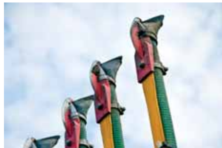
Pätkový aplikátor Glide-Fix so záberom 18 m má pokojný chod a presne kopíruje nerovnosti. Pätky vytvárajú jemné drážky, ktoré pomáhajú vsakovaniu tekutín.
