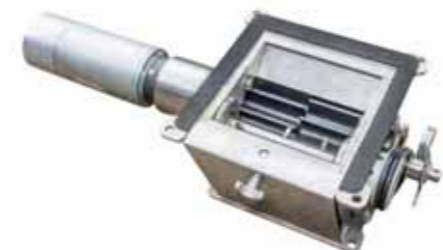
Dávkovacie ústrojenstvo Ferti-Boxu z nehrdzavejúcej ocele poháňa elektromotor na základe signálov z radaru alebo traktora cez Isobus.
