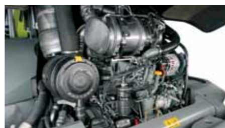
Motor s objemom 4,5 l naladili na tri výkony. Emisné limity spĺňa pomocou SCR, DOC a filtra pevných častíc. V prípade nevhodných podmienok možno vypaľovanie filtra manuálne oddialiť.
