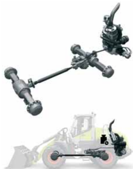
Schéma systému pohonu a umiestnenie motora vzadu, kde tvorí protizávažie nákladu.
