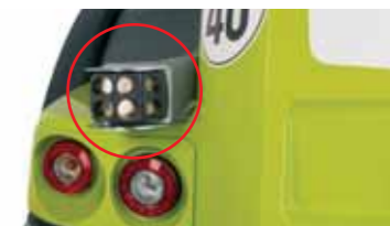
K bezpečnostným prvkom patrí integrovaná zadná kamera a zadný detektor prekážok so svetelnou a akustickou signalizáciou.
