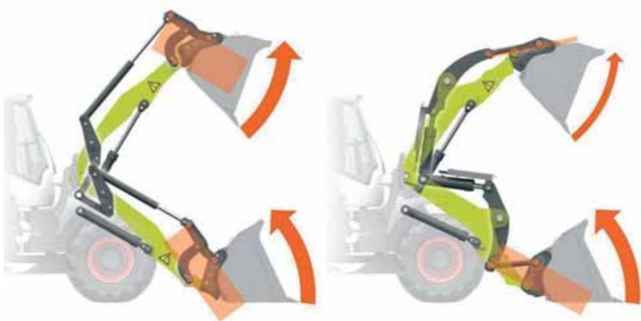
Claas ponúka na výber medzi P a Z kinematikou výložníka.
