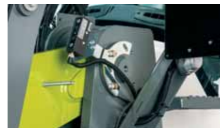
Súčasťou inteligentného systému nakladania Smart Loading je aj vážiace zariadenie.
