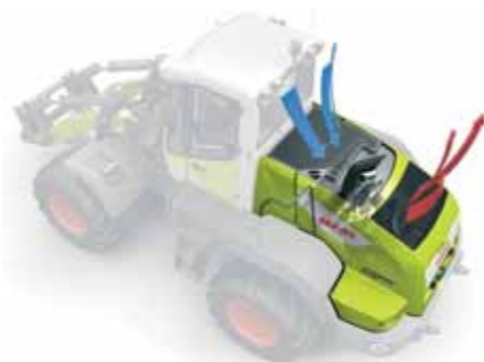
Chladiče tesne za kabínou nasávajú relatívne čistý vzduch. Pre extrémne prašné prostredie možno objednať väčšiu mriežku s jemnejším sieťovaním.
