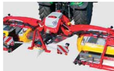
Kombináciu možno odstaviť na integrované nohy so zhadzovacími pásmi aj v prepravnej polohe. Manipuláciu s Collectorom uľahčuje podvozok.
