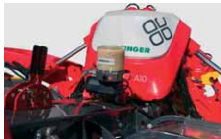
Automatické mazanie zvyšuje spoľahlivosť a životnosť.
