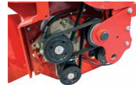
Z dôvodu plynulejšieho prechodu hmoty sú poháňané oba valce miagača. Výrobca použil ozubený remeň pre tichší chod a zamedzenie rizika kontaminácie olejom.
