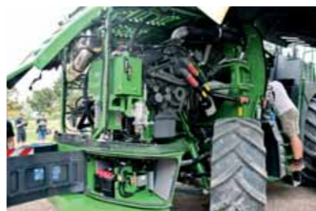
Konštruktéri vylepšili prístup k motoru, chladičom a komponentom toku materiálu. Servisné miesta vybavili svetlometmi. Rezačky poháňajú motory Liebherr s objemom 16,16 l.
