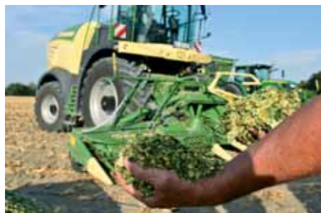
Planetovou prevodovkou VariLOC na remenici bubna zmeníte dĺžku rezanky bez zložitej zmeny počtu nožov bubna.
