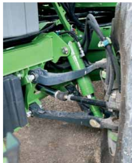
Úplne nová zadná náprava má individuálne zavesené a odpružené kolesá s rejdrom 50°, na želanie aj s pohonom. Možnosť zmeny výškovej polohy nábojov kolies na prednej náprave umožňuje osádzať pneumatiky viacerých rozmerov.
