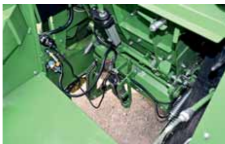
VariQuick urýchľuje a uľahčuje výmenu trávnej šachty za kukuričný kondicionér.
