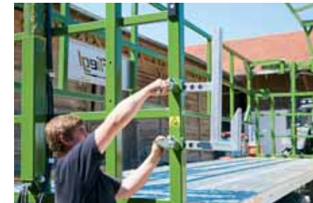
Variabilné nastavenie zábrany pre prispôbenie šírke balíkov.
