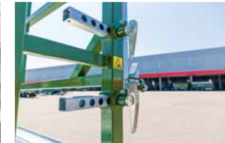
Variabilné nastavenie zábrany pre prispôbenie šírke balíkov.
