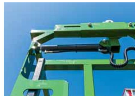
Mreža sa ovláda hydraulicky, opatrená môže byť plachtou alebo sieťkou pre zabránenie ušpinenia a odlietavania stebiel.
