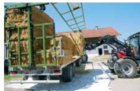
Rýchle naloženie a vyloženie z oboch strán a rýchle a pohodlné zaistenie balíkov sú hlavné výhody voza Fliegl DPW 210 BL Profi.
