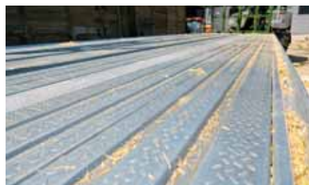
Detail na protišmykovú pozinkovanú podlahu Power Grip.
