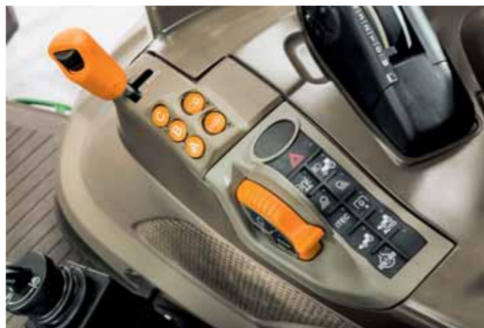
Hlavné ovládacie prvky umiestnili na lakťovú opierku. Automatické funkcie prevodovky uľahčujú obsluhu.
