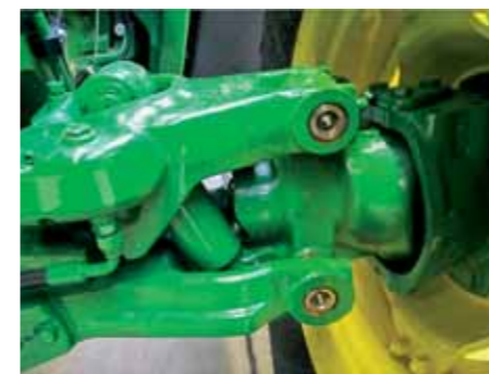
Predná náprava s individuálne odpruženými kolesami otáča traktor na polomere 3,75 m.
