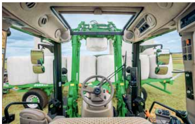
Panoramatické čelné okno, brzda s funkciou spojky, do joysticku integrované radenie stupňov a reverzná funkcia spolu s flexibilným natáčaním nápravy robia prácu s čelným nakladačom ideálnou.
