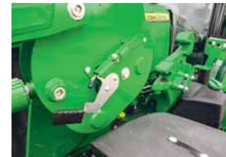
Click-&Go spolu s multispojku uľahčujú pripájanie a odpájanie čelného nakladača. Ten je uchytený priamo na rám stroja.
