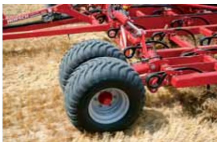
Predné oporné kolesá môžu byť dvojité alebo jednodielne. V závislosti na vlhkosťných podmienkach kolesá môžete dopĺňať alebo odobrať.
