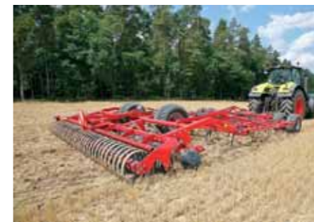
Za radličkovou sekciou pôdu urovnáva nivelátor alebo rad tanierov.
