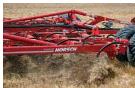
Päť a šesť metrová verzia sa na úvrati otáča na predných oporných kolesách a kolesách podvozka, 10 a 12 m verzia na predných kolesách a valcoch. Prepojené sú tiahkami, čo zabezpečuje jednotné nastavenie a udržiavanie pracovnej hĺbky.
