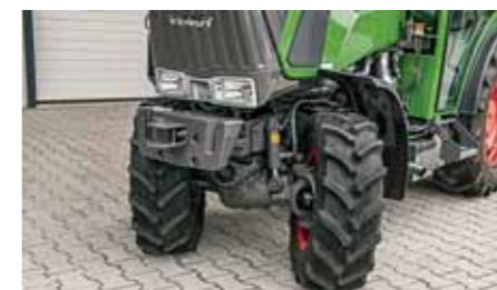
Uhol vytočenia kolies 58° spolu s VarioActive funkciou zvyšuje obratnosť a pohodlie otáčania na koncoch radov.
