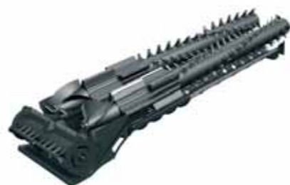
Axiálnemu mlátiaciu a separácii Dual Helix predchádza tangenciálny rotor.
