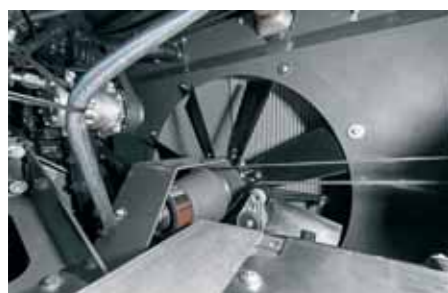
Automatický čistiaci systém AirSense monitoruje teplotu chladiacej kvapaliny a podľa toho automaticky reverzuje ventilátor, ak nie je potreba, každých 15 minút.
