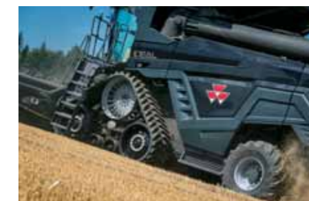
S pásovým podvozkom neprekročíte 3,3 m šírku a rýchlosť 40 km za hodinu. Obuť môžete aj pneumatiky široké 800 mm.
