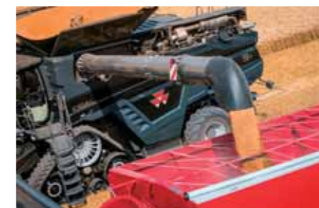
Vyprázdňovacia závitovka s priemerom 46 cm vyprázdni 14 t pšenice za 1,5 minúty na vzdialenosť 10,6 m.
