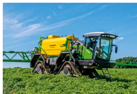
Samohybný postrekovač na pásovom podvozku Dammann-trac DT 2800H S5 EcoDrive™
