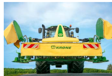
Čelná žacia lišta Krone Easy Cut F 400 CV Fold
